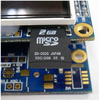
図. 3. 7. MicroSD カード挿抜図
